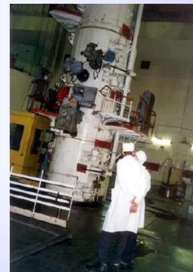
**Macchina di carico e scarico combustibile 250 t**
