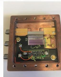
Rivelatori superconduttori a transizione di fase (TES)
